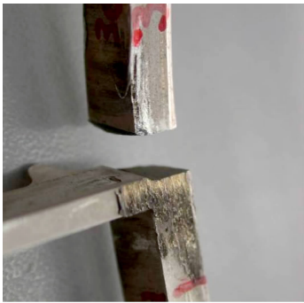
图 4 保持架断口附近表面形貌 Fig. 4 Surface appearance of the fracture on the cage
